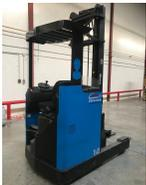
Chariot élévateur à mât rétractable > 6mètres
